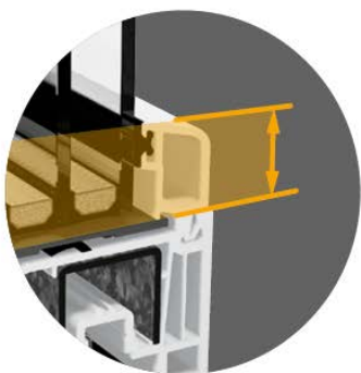
Een hoge glaszet door een overslaghoogte van 26 mm voor een betere warmte-isolatie.
