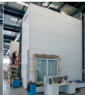
lucht-, wind- en water-testinstallatie
