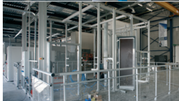
cyclische en mechanische testinstallatie
